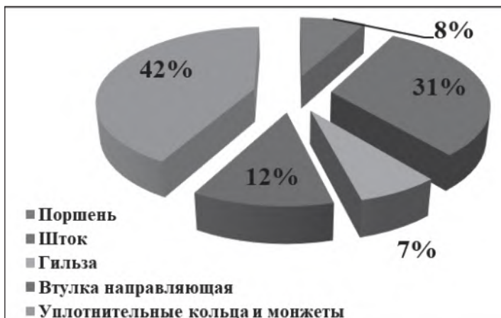
Рис. 3. Доля отказов, приходящихся на детали гидроцилиндра: 8% – поршень; 31% – шток; 7% – гильза (цилиндр); 12% – втулка направляющая; 42% – уплотнительные кольца и манжеты
